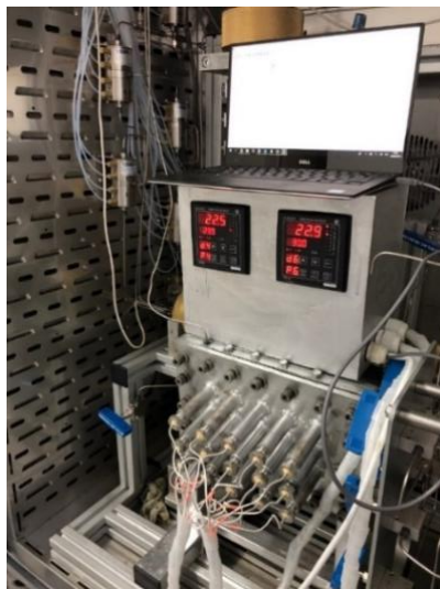
Рисунок 3.19 – Физическая 3D модель, оборудованная тепловыми датчиками
