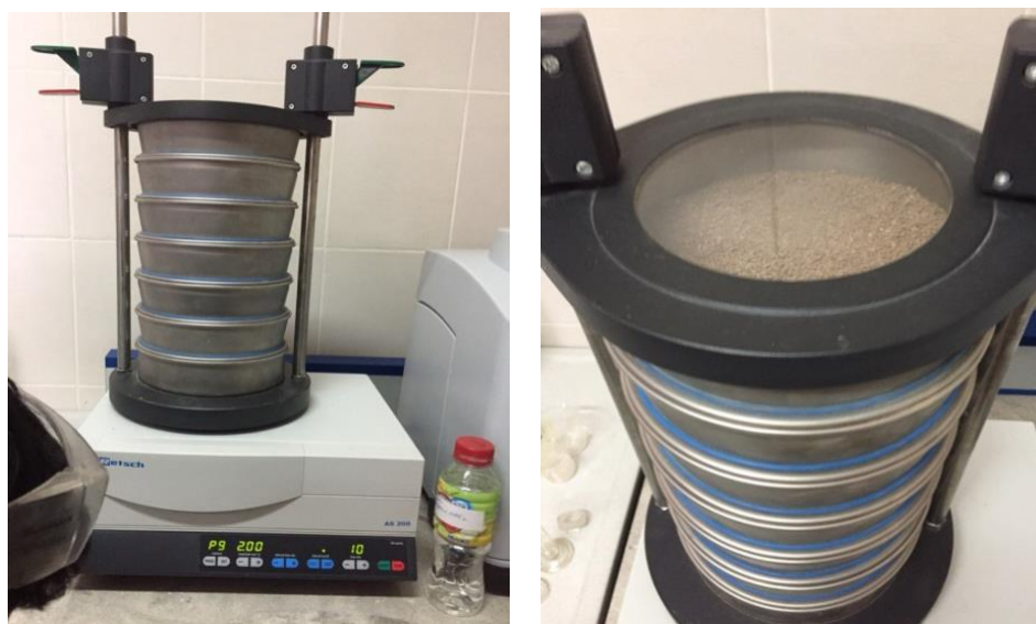
Рисунок 3.10 - Вибропривод (продолжительность процесса 25 мин.)
