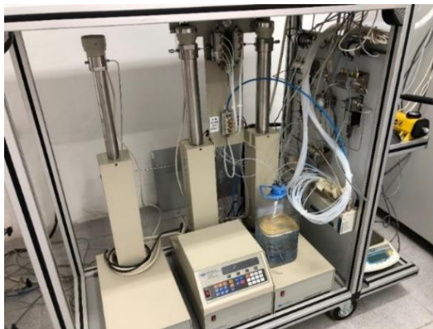
Рисунок 3.18 – Насосы для закачки разогретой нефти в физическую модель
